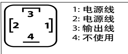
电气连接/接线
