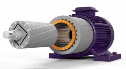
Moteur PM à démarrage direct avec aimants cachés et cage de rotor
