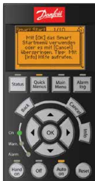
Eenvoudige inbedrijfstelling. Functies zoals Danfoss Smart Start maken de inbedrijfstelling van frequentieregelaars een stuk eenvoudiger. Hierbij wordt de gebruiker door de basisinstellingen voor de regelaar geleid.
