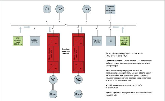
Пример функции ограничения мощности на борту судна с гибридной силовой установкой: при отключении одного генератора выработка мощности ограничивается возможностями двух других генераторов, что предотвращает их перегрузку и обеспечивает возможность продолжения работы.
