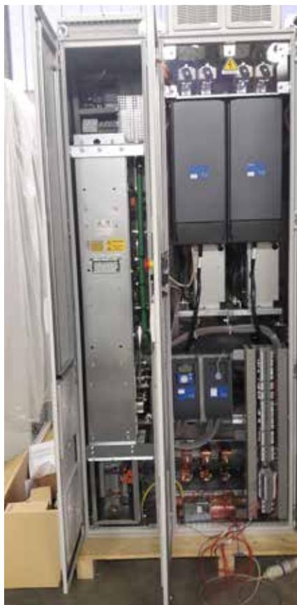
Quadro elettrico destinato al termovalorizzatore di Edimburgo in fase di collaudo finale nella fabbrica di Casagrande Elettrocostruzioni a Verona
