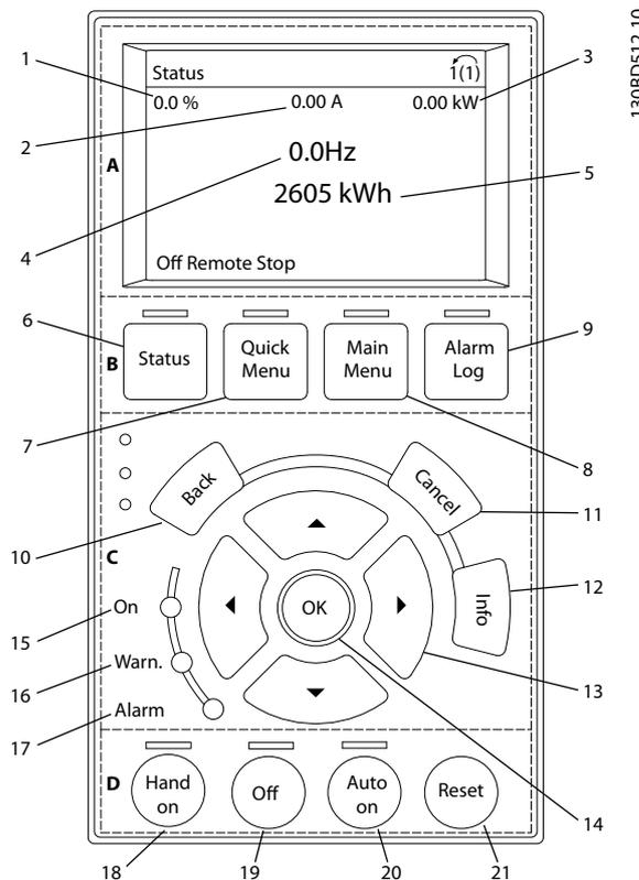
Abbildung 5.1 Bedieneinheit (LCP)
