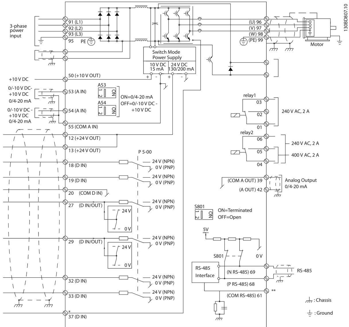
Abbildung 4.1 Anschlussplan des Grundgeräts
