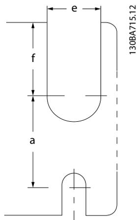
Abbildung 3.5 Obere und untere Bohrungen (B4, C3, C4)
