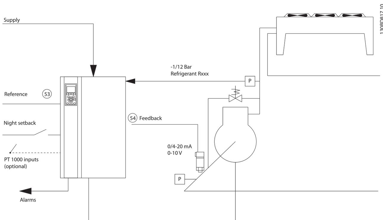
Abbildung 6.1 Standardzeichnung eines „Verdichters mit interner Regelung“
