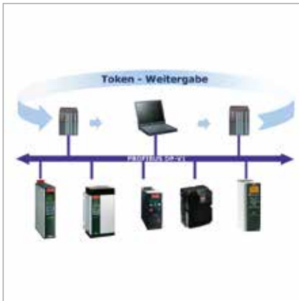
Einfache Kommunikation über die bestehende Profibus-Verdrahtung mittels PROFIBUS DPV1
