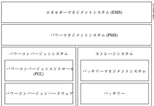
図 4: 制御システムの一般的なレイヤー
