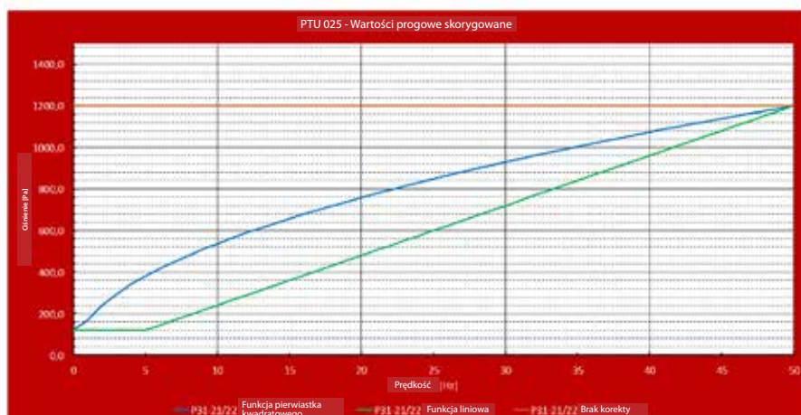
Ustawienia krzywej ciśnienia/prędkości
