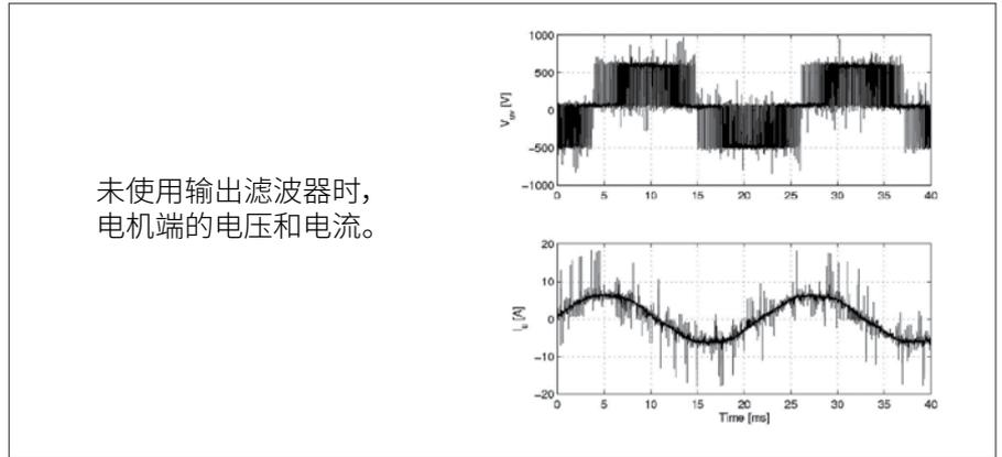
**正弦波滤波器**是一种差模低通滤波器，用于变频器输出端，可抑制变频器的开关频率组件，并对变频器的相间输出电压进行平滑处理以使其变为正弦型。
