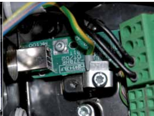
Eenvoudig toegankelijke klemmen voor intern doorlussen
