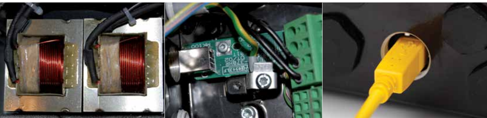
Beépített DC-tekercek a harmonikussterhítés korlátozásához
