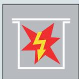
Con la protezione dall'esplosione di classe "d", il dispositivo è progettato per assicurare che in caso di scintilla in un'area protetta (quale l'interno di un contenitore), essa non possa attraversare l'area protetta.
