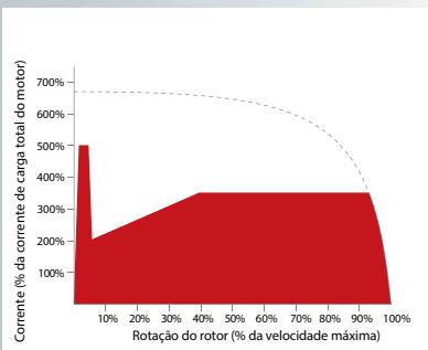
Corrente constante/rampa de corrente – mostrada aqui com arranque
