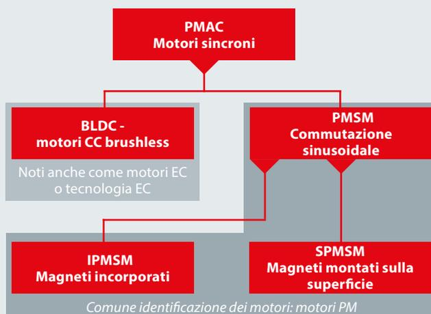
PMAC = Magnete permanente CA; BLDC = Motore CC Brushless; PMSM = Motore sincro a magneti permanenti; IPMSM = PMSM interno (magnetni incorporati); SPMSM = PMSM in superficie (magnetni montati sul rotore)
