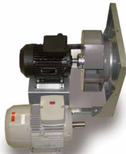
Usporedbe parametara standardnog trofaznog asinkronog motora (ispod) i PM motora optimiziranog kućišta (gore)
