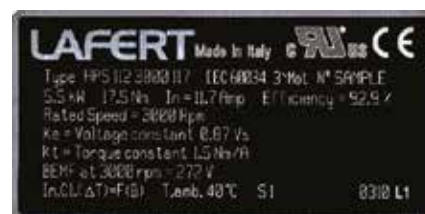
Tehničke podatke motora potrebno je unijeti u odgovarajuće parametre frekvencijskog pretvarača. Potrebni podaci se nalaze na natpisnoj pločici ili u tehničkoj dokumentaciji motora.
