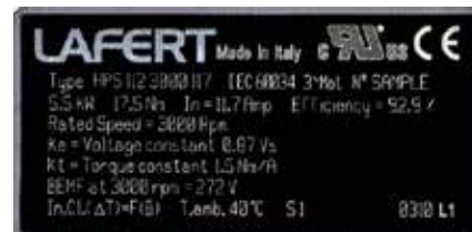
Параметрите в честотния преобразувател са въведени в съответствие с данните от таблицата на електрическия мотор и техническата му спецификация.
