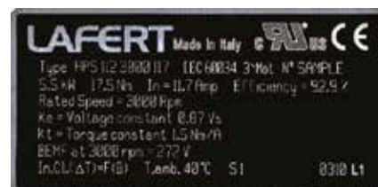
Parametrii convertizorului sunt introduși conform informațiilor de pe plăcuța motorului și a fișei tehnice a acestuia.
