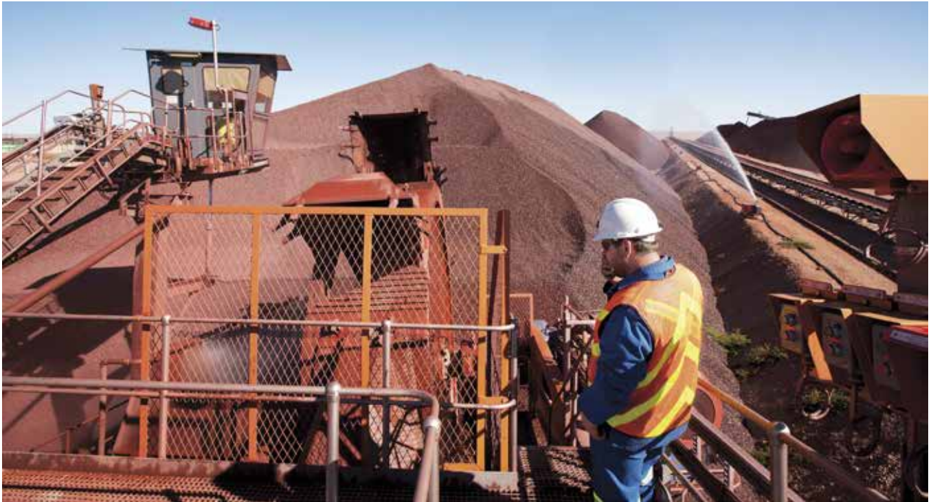
Działająca zwałowarka/czerparka w kopalni Kolomela
