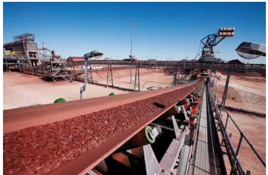
Wysokogatunkowe żelazo transportowane przez przenośnik do terminala wyładunkowego w kopalni Kolomela
