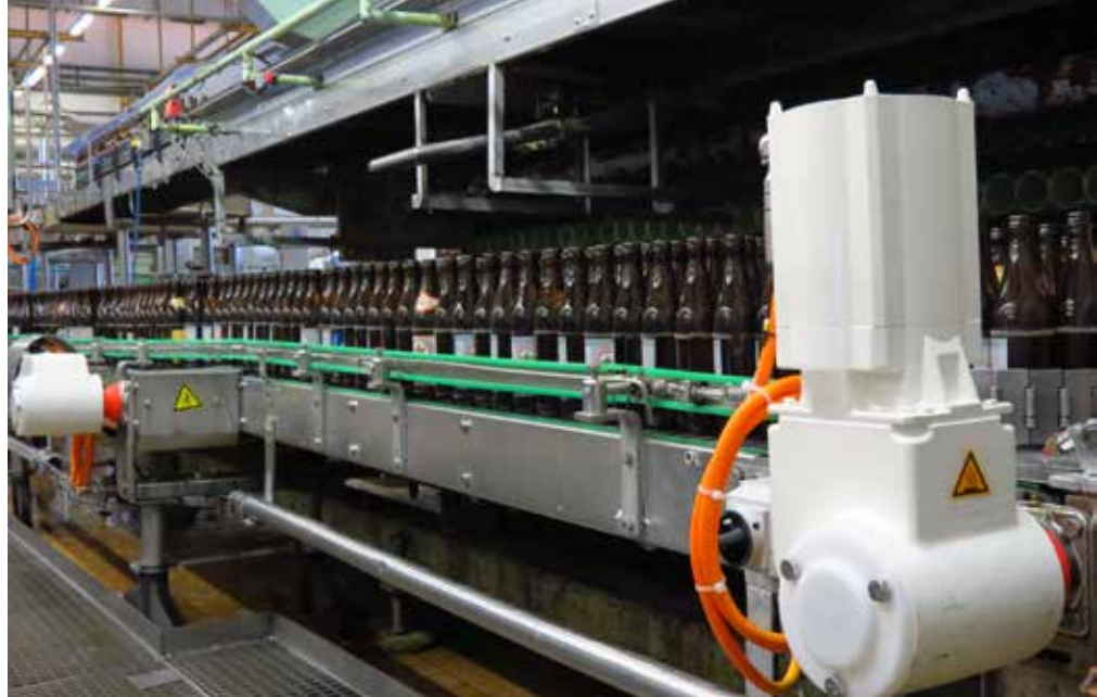
VLT® OneGearDrive® jest montowany bezpośrednio na wale przęnośnika.
