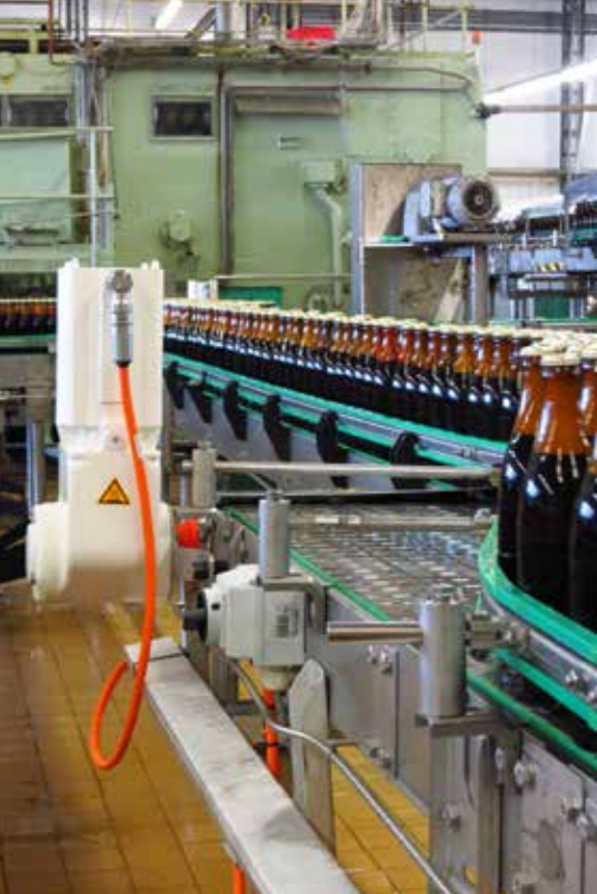
VLT® OneGearDrive® jest montowany bezpośrednio na wale przęnośnika.
