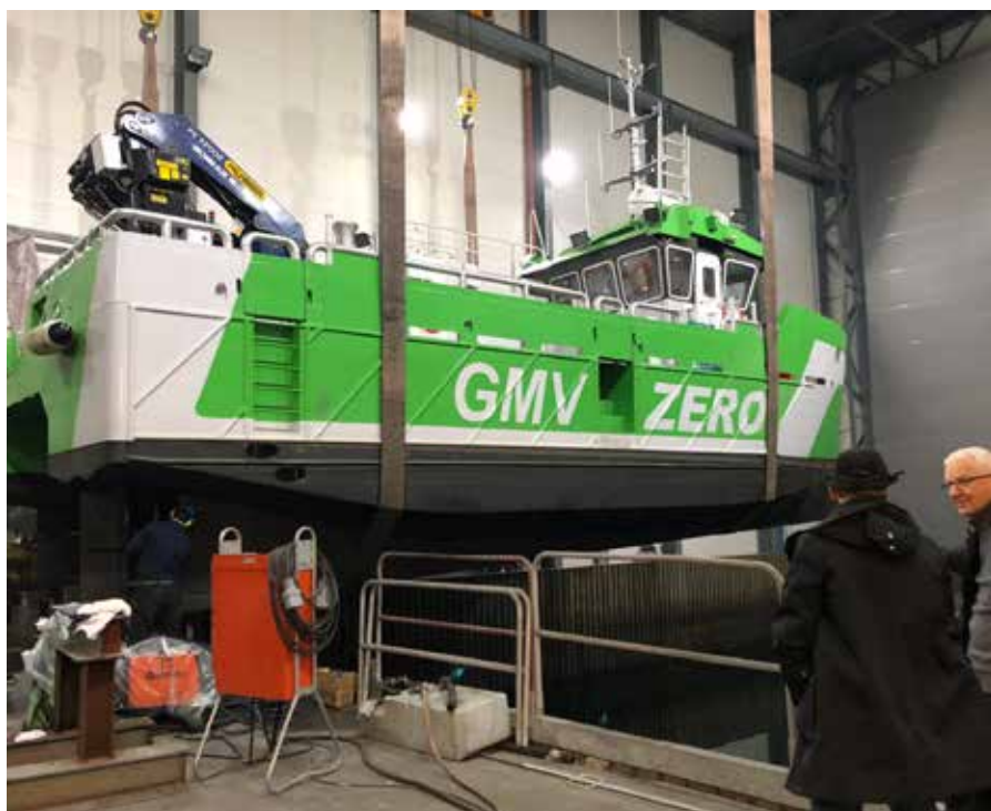
Astrid Helene är en 14 meter lång och 8 meter bred aluminiumarbetsbåt av katamarantyp. Bild från byggandet av båten vid Grovfjord Mekaniske Verksted.
