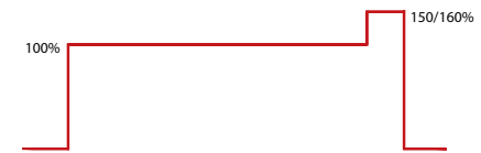
Profil de frânare specific pentru mișcarea pe verticală (ciclu de funcționare 40%)
