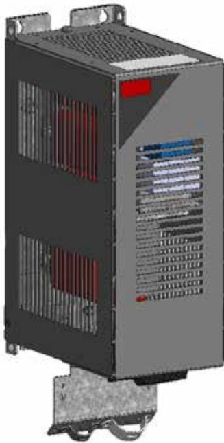
Les filtres de sortie VLT® All-mode MCC 201 sont des filtres sinus passe-bas bimode fonctionnant en mode différentiel et en mode commun. Ces filtres suppriment la composante de fréquence de commutation du variateur et lissent la tension de sortie phase-phase et phase-terre du variateur pour la rendre sinusoïdale.
