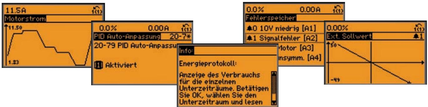
Die Parametrierung, Steuerung und Überwachung des VLT® AQUA Drive erfolgt mit Hilfe einer einheitlichen Bedienoberfläche (LCP – Local Control Panel).
