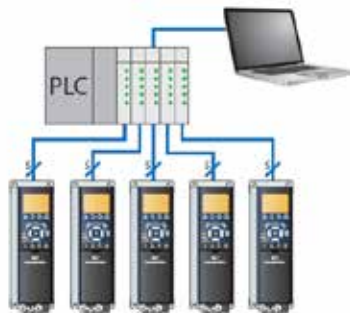
Fig. 9.8 Traditionele bedrading. Geen veldbus
