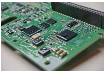
Fig. 10.12 Printplaat met vormvolgende coating
