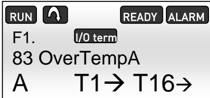
Kuva 5.1-2 Korkean lämpötilan hälytys NXP-paneelissa
