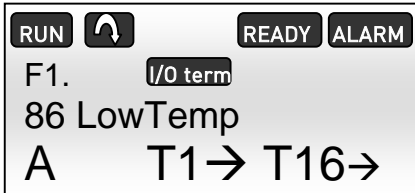
Kuva 5.1-3 Matalan lämpötilan hälytys NXP-paneelissa
