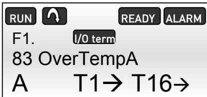
Kuva 5.1-2, Korkean lämpötilan hälytys NXP-paneelissa
