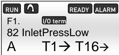
图 5.1-4 NXP 面板上的低压报警
