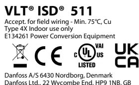
Abbildung 65: Rückverfolgungs- und Konformitätsetikett auf der Elektronikabdeckung des ISD 511
