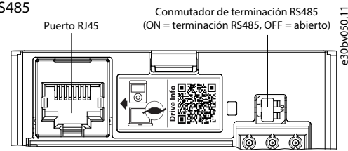
Ilustración 4: Puerto RJ45 y conmutador de terminación RS485
