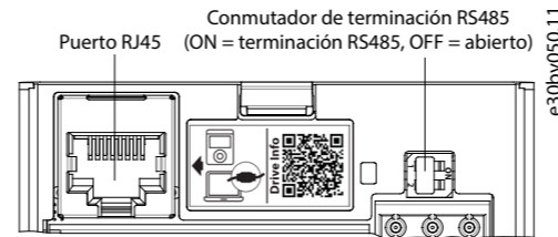
Ilustración 4: Puerto RJ45 y conmutador de terminación RS485
