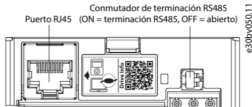
Ilustración 4: Puerto RJ45 y conmutador de terminación RS485
