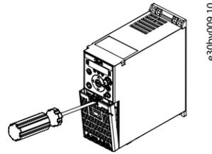
Ilustração 2: Removendo a tampa dos terminais
