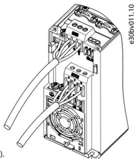
Ilustração 1: Montagem dos Cabos de Aterramento, Rede Elétrica e Motor
