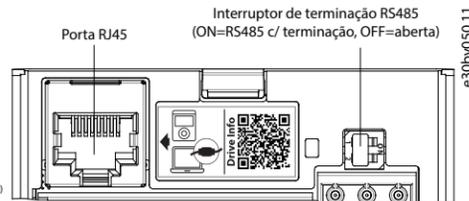
Ilustração 4: Porta RJ45 e chave de terminação RS485
