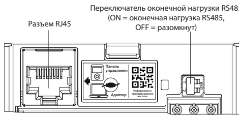
Рис. 4. Разъем RJ45 и переключатель оконечной нагрузки RS485
