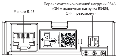
Рис. 4. Разъем RJ45 и переключатель оконечной нагрузки RS485
