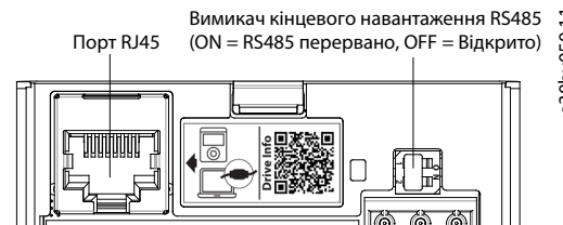
Ілюстрація 4: Порт RJ45 і вимикач кінцевого навантаження RS485
