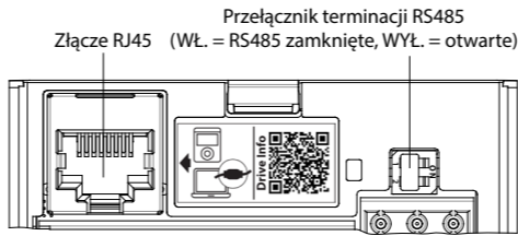
Ilustracja 4: Złącze RJ45 i mikroprzełącznik zamykający obwód RS485
