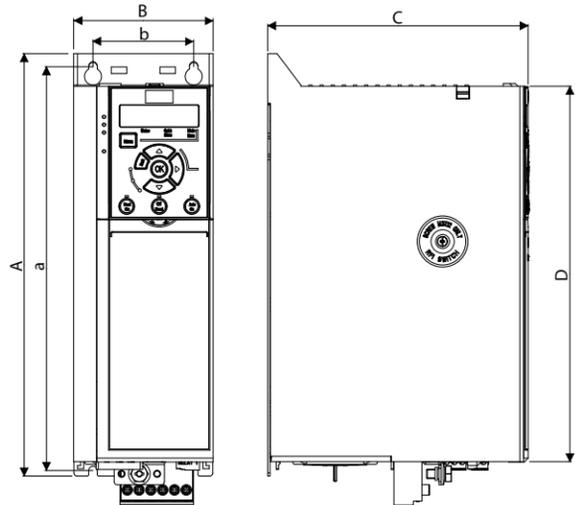
Ilustração 1: Dimensões mecânicas, gabinetes de tamanho J1-J7
