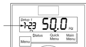
Illustration 7.4 Indication du numéro du paramètre sélectionné
