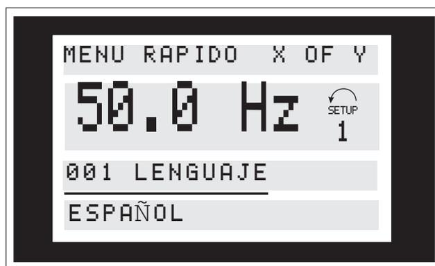
En la parte inferior de la pantalla, se dan el número y nombre del parámetro, junto con el estado y valor del primer parámetro de la configuración rápida. La primera vez que se pulsa la tecla [Quick Menu] después de encender la unidad, las lecturas empiezan en la pos. 1, consulte *Tabla 3.6*.
