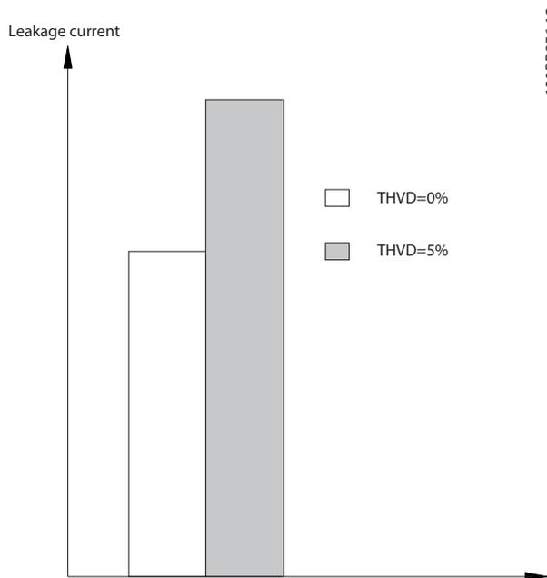
图 2.32 线路失真对漏电电流的影响。
