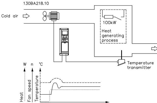
图 2.26 通风系统中的过程 PID 控制
