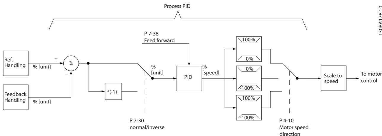
图 2.25 过程 PID 控制图
