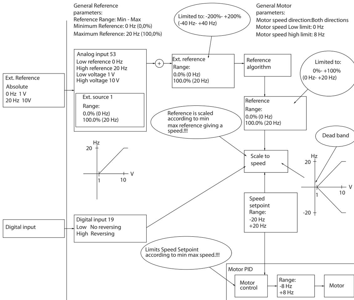
图 2.22 锁定极限在最小至最大极限范围之内的参考值输入
