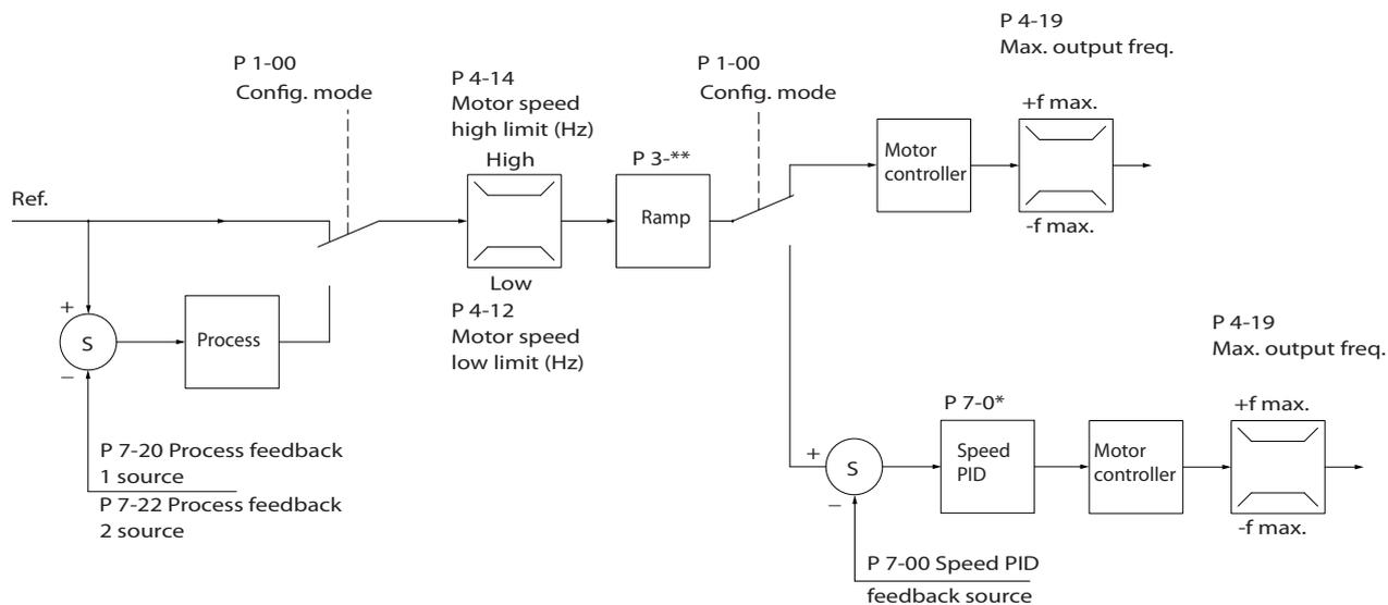
图 2.14 VVC<sup>+</sup> 开环和闭环配置下的控制结构
