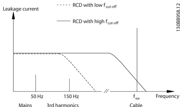
图 2.33 漏电电流的主要成分
