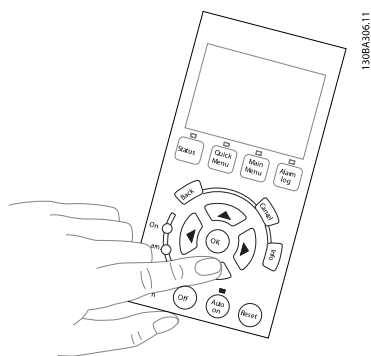
Disegno 5.26 Fase 7: Per muovere il cursore, utilizzare i tasti a freccia Sinistra ◀ e Destra ▶. In questo modo è possibile modificare la velocità con incrementi maggiori.
