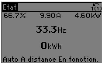
Illustration 6.2: Étape 1 : mettre le variateur de fréquence sous tension (voyant jaune allumé).
