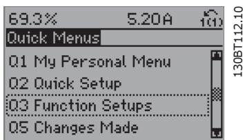
Disegno 6.4: Fase 3: Utilizzare i tasti di navigazione Su/Giù per scorrere verso il basso fino a Setup funzioni. Premere [OK].
