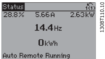
Disegno 6.2: Fase 1: Accendere il convertitore di frequenza (il LED giallo si accende)
