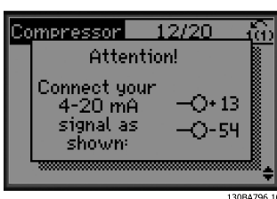
图 3.13 信息：选择了 4-20 mA 反馈 - 进行相应连接
