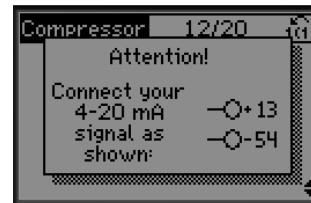
Ábra 3.13 Infó: 4–20 mA-es visszacsatolás lett kiválasztva – a csatlakoztatás ennek megfelelő legyen
