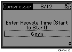
Ábra 3.8 Min. idő két indítás között
