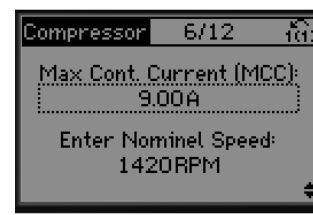
Ábra 3.6 Áram és névleges fordulatszám beállítása
