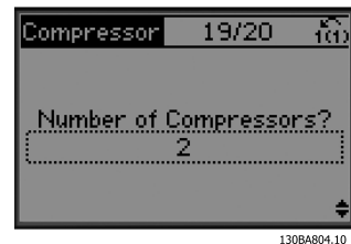
Ábra 3.21 A csoportaggregátba tartozó kompresszorok számának megadása
