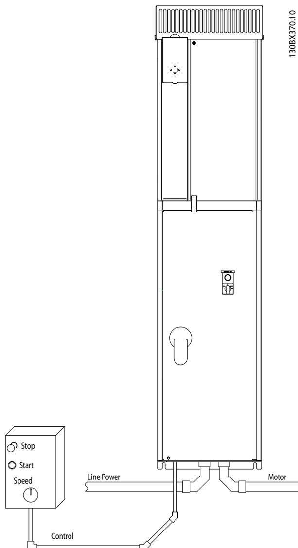
**Ilustração 4.4 Exemplo de Instalação Elétrica Adequada Usando Conduíte**
