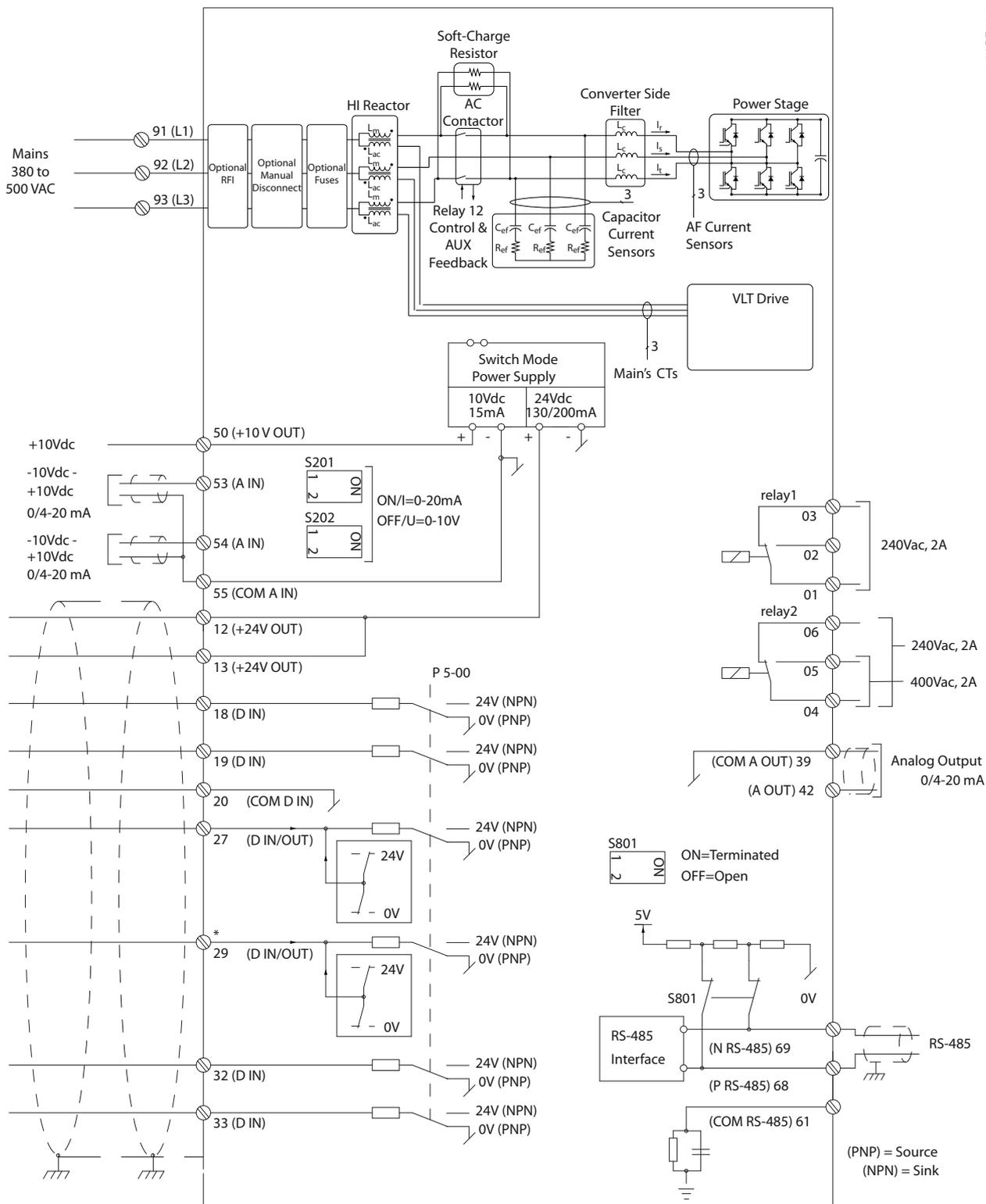
Ilustração 4.14 Diagrama do Terminal para o Filtro Lateral
