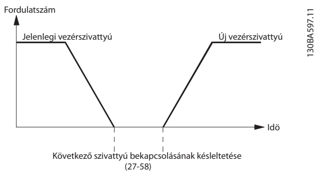
Ábra 3.111 Következő szivattyú üzemeltetésének késleltetése
