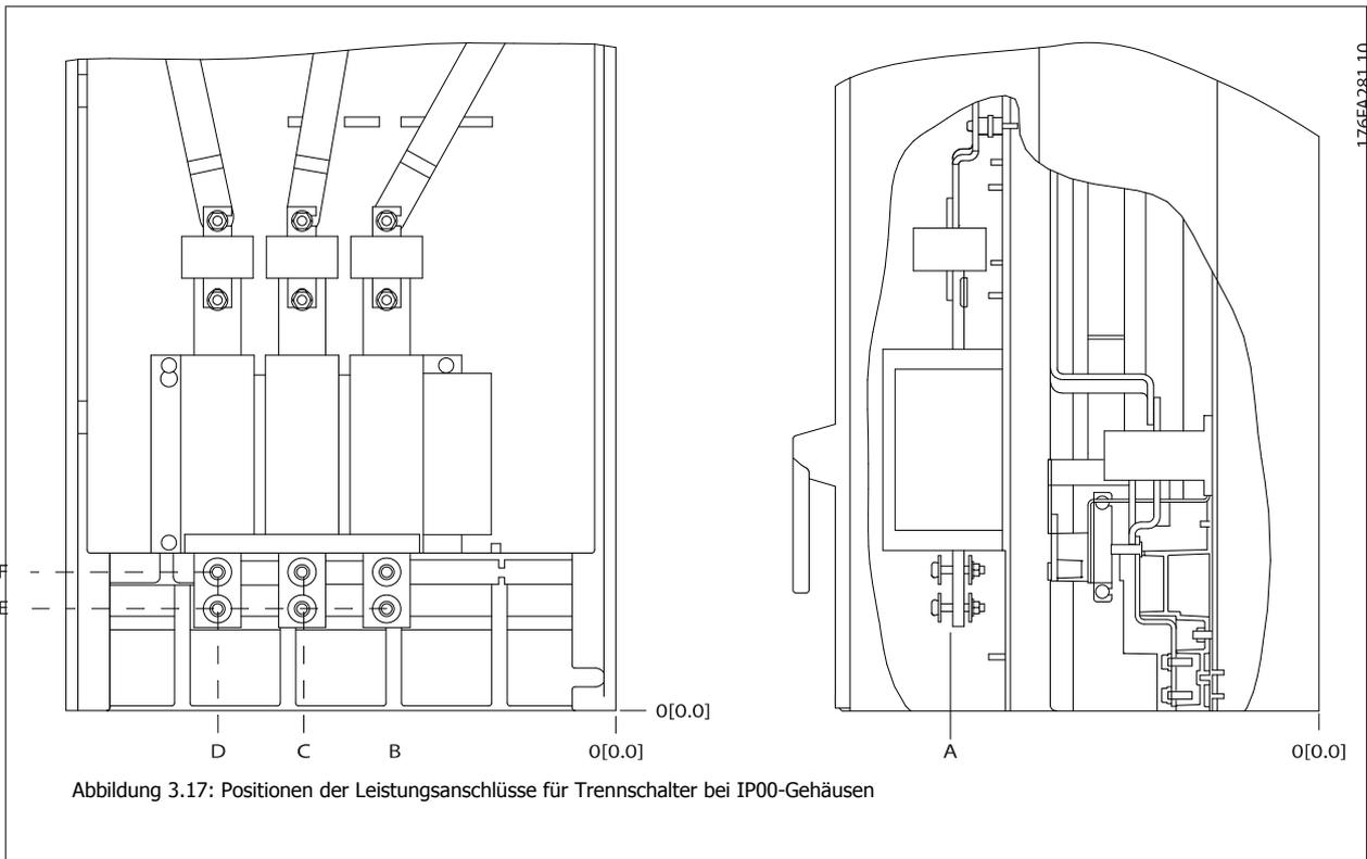
Beachten Sie, dass die Leistungskabel schwer und schwierig zu biegen sind. Achten Sie auf optimale Positionierung des Frequenzumrichters, um einfache Installation der Kabel sicherzustellen.
