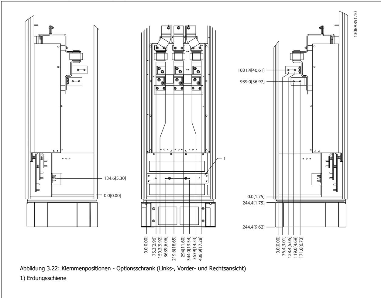
**Klemmenpositionen - Optionsschrank mit Hauptschalter/Kompaktleistungsschalter (Baugrößen F3 und F4)**
