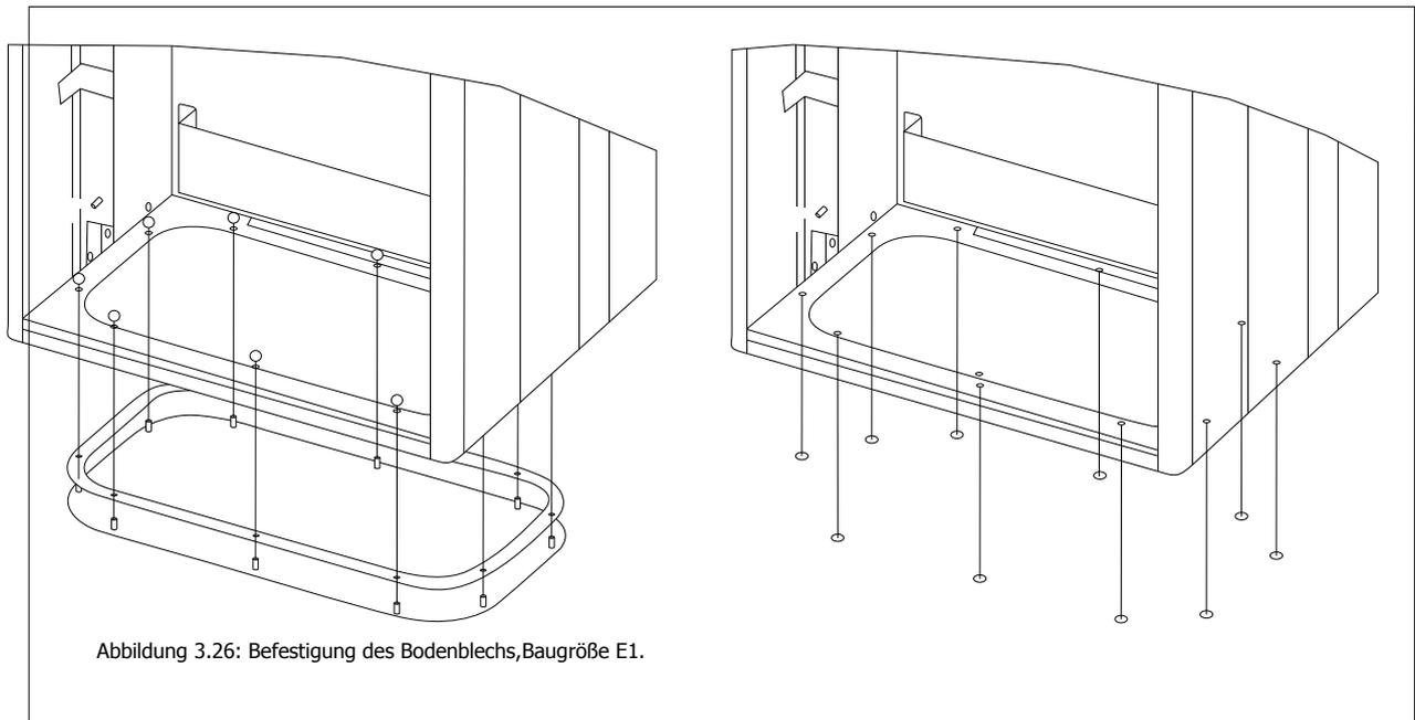
Abbildung 3.26: Befestigung des Bodenblechs, Baugröße E1.
