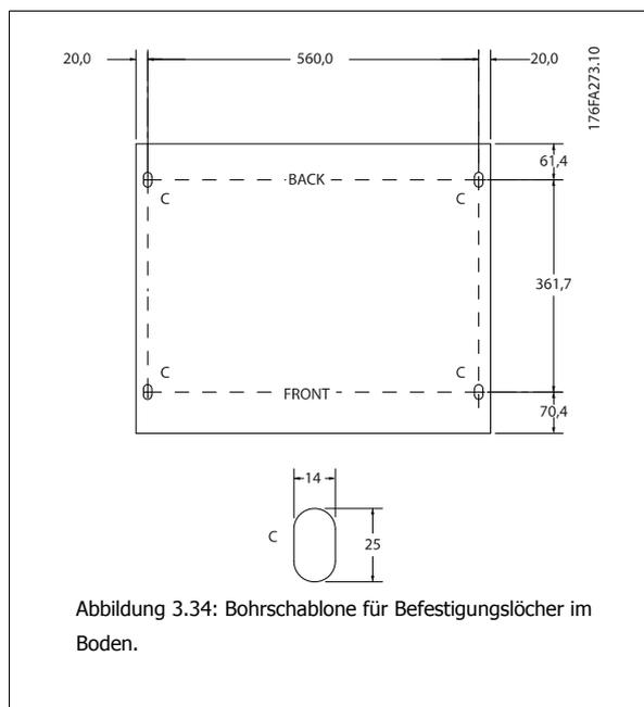
Setzen Sie den Frequenzumrichter auf den Sockel, und befestigen Sie ihn mit den mitgelieferten Schrauben laut Abbildung am Sockel.
