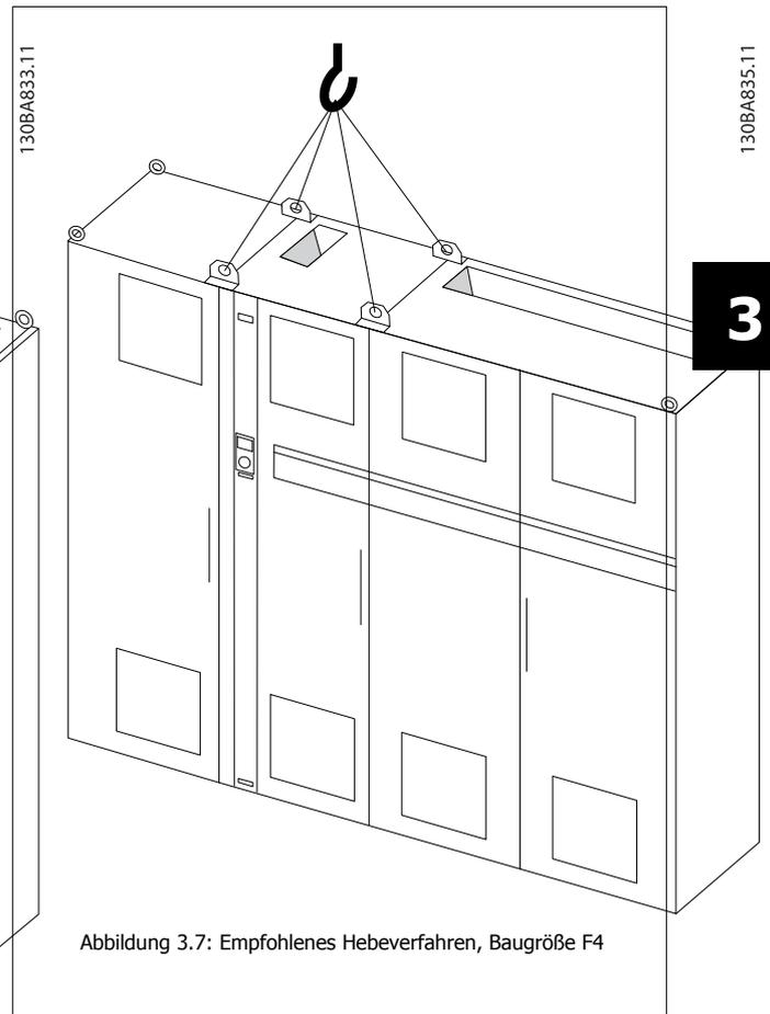
Abbildung 3.7: Empfohlenes Hebeverfahren, Baugröße F4
