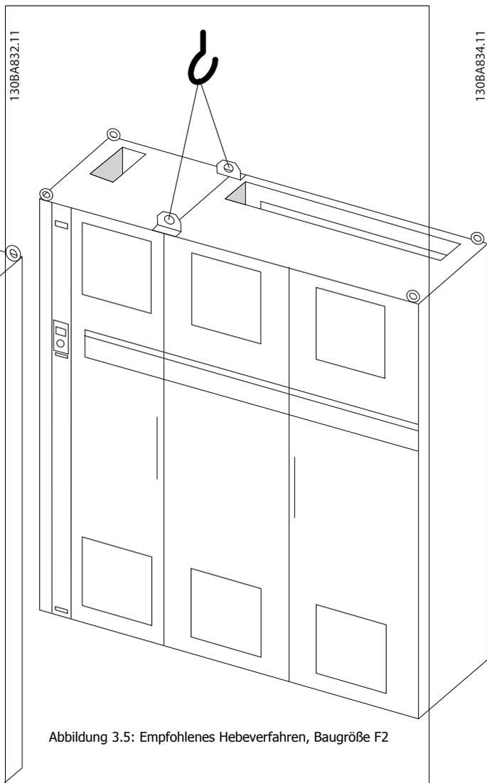
Abbildung 3.5: Empfohlenes Hebeverfahren, Baugröße F2
