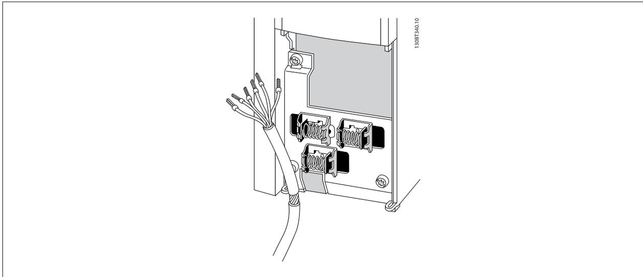
Schließen Sie die Leitungen wie im Produkthandbuch des Frequenzumrichters beschrieben an. Denken Sie daran, die Abschirmungen ordnungsgemäß anzuschließen, um optimale elektrische Störfestigkeit sicherzustellen.
