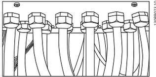
Abbildung 3.25: Beispiel für richtige Befestigung des Bodenblechs.
