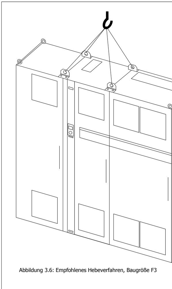
Abbildung 3.6: Empfohlenes Hebeverfahren, Baugröße F3
