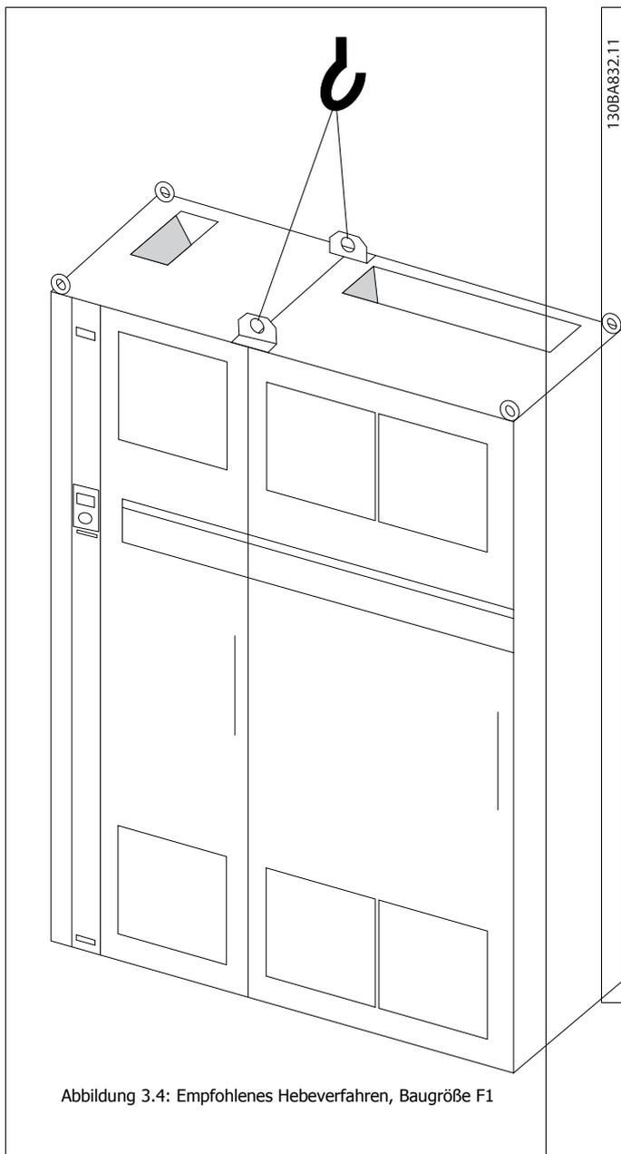
Abbildung 3.4: Empfohlenes Hebeverfahren, Baugröße F1
