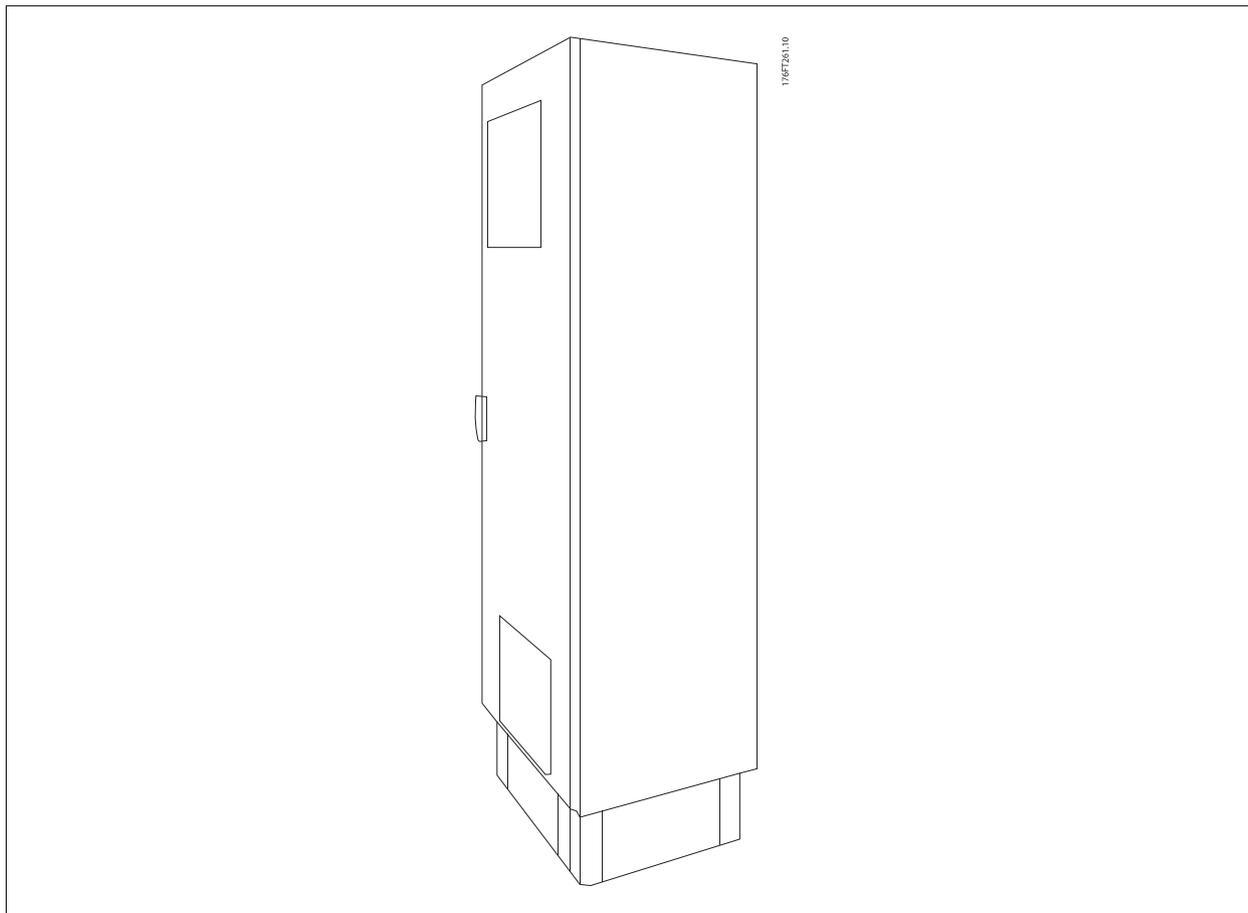
Dieser Abschnitt beschreibt die Installation von NEMA 3R-Einbausätzen für Frequenzumrichter mit den Baugrößen D3, D4 und E2. Diese Einbausätze sind für die Installation von IP00/Chassis-Versionen dieser Baugrößen in Rittal TS8 NEMA 3R- oder NEMA 4-Schaltschränken ausgelegt und getestet. Das NEMA-3R-Gehäuse ist ein Außengehäuse, das einen gewissen Schutz gegen Regen und Eis bietet. Das NEMA-4-Gehäuse ist ein Außengehäuse, das einen größeren Schutz gegen Wetter und Strahlwasser bietet.
