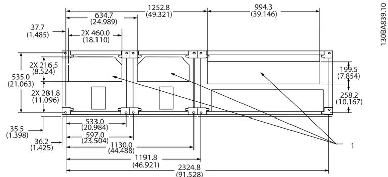
F1-F4: Ansicht der Kabeleinführungen von der Unterseite des Frequenzumrichters – 1) Kabelkanäle in markierten Bereichen platzieren
