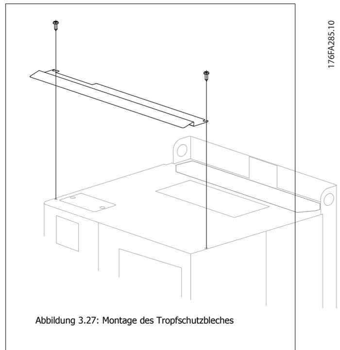
Abbildung 3.27: Montage des Tropfschutzbleches
