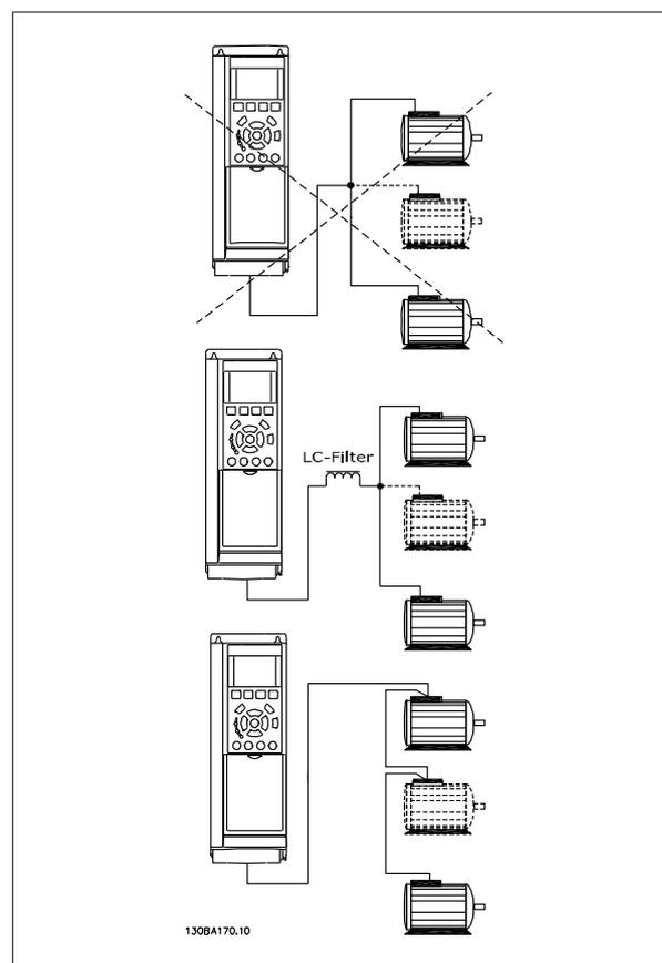
Beim Start und bei niedrigen Drehzahlen können möglicherweise Probleme auftreten, wenn die Motorgrößen sehr unterschiedlich sind, da bei kleinen Motoren der relativ hohe ohmsche Widerstand im Stator eine höhere Spannung beim Start und bei niedrigen Drehzahlen erfordert.
