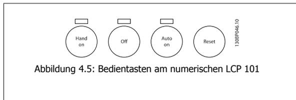
Abbildung 4.5: Bedientasten am numerischen LCP 101
