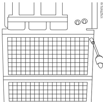
Abbildung 3.50: Montage der EMV-Abschirmung.
