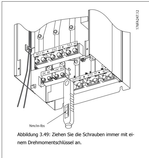
Abbildung 3.49: Ziehen Sie die Schrauben immer mit einem Drehmomentschlüssel an.
