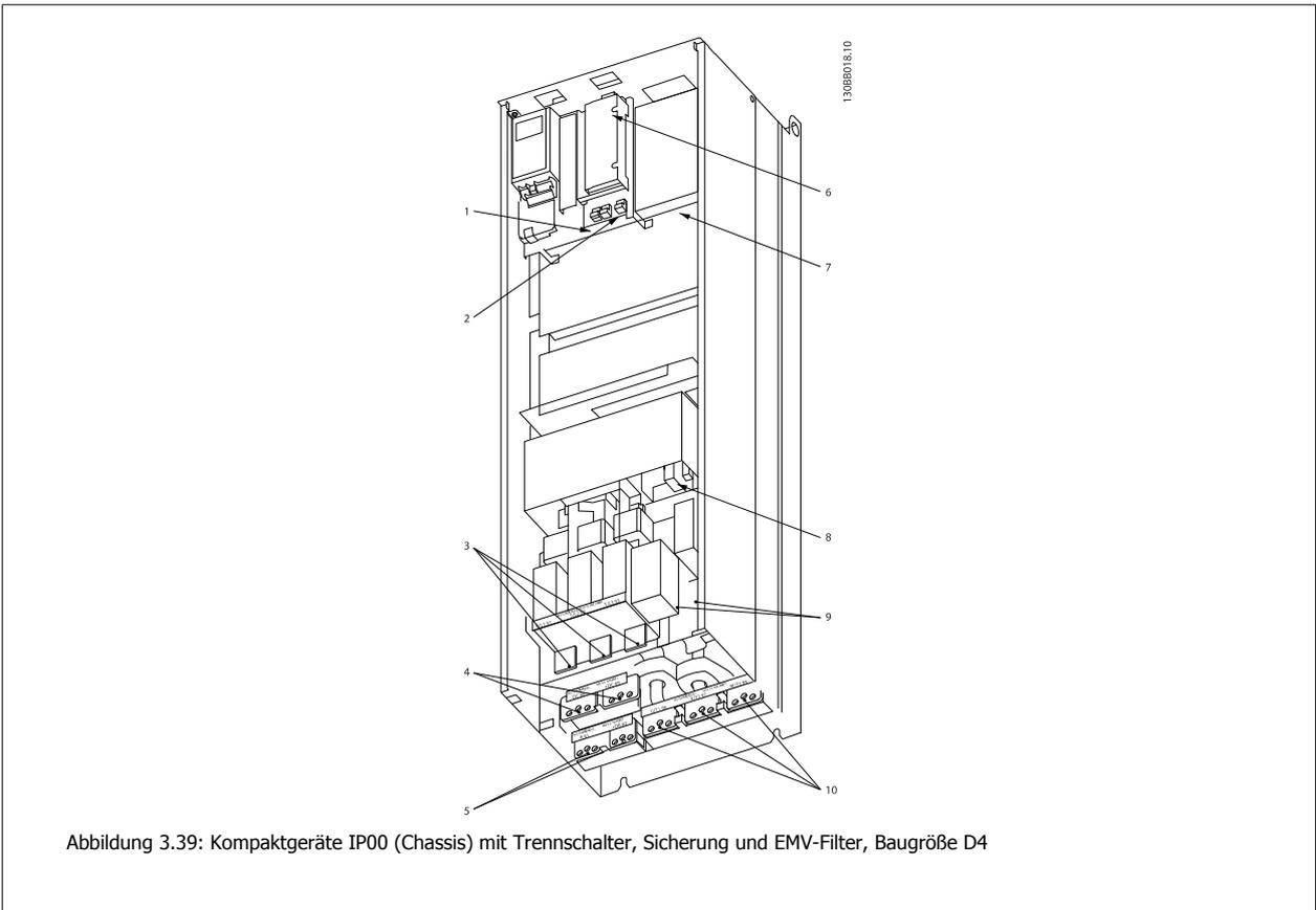
Abbildung 3.39: Kompaktgeräte IP00 (Chassis) mit Trennschalter, Sicherung und EMV-Filter, Baugröße D4
